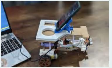
LINE FOLLOWER ROBOT (L.F.R.) EQUIPPED INTEGRATED WITH BLUETOOTH CONTROLLER AND CAMERA FOR REMOTE OPERATION.
