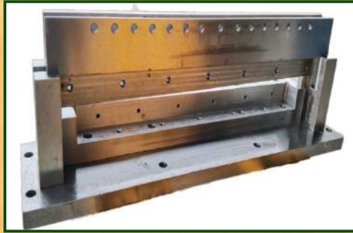
Press Machine Cutting blade Die Holder
